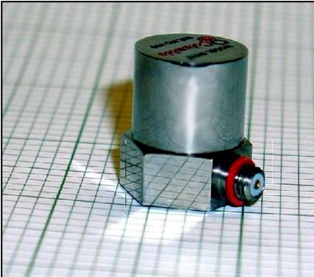
Fig. 16. Piezoelectric sensor
