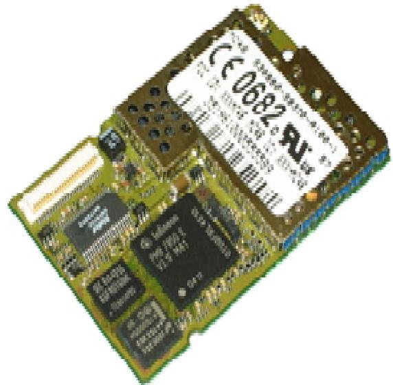
Fig. 4 GSM module IC
