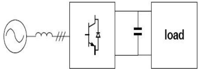
Fig.1.3 PWM rectifier
