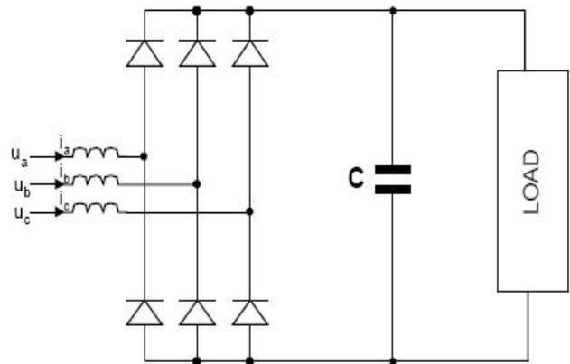
Fig. 2.1 Diode Rectifier
