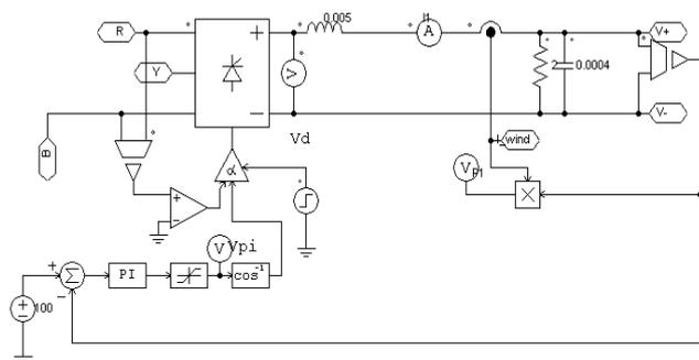
Fig 3: The rectifier sub-circuit
